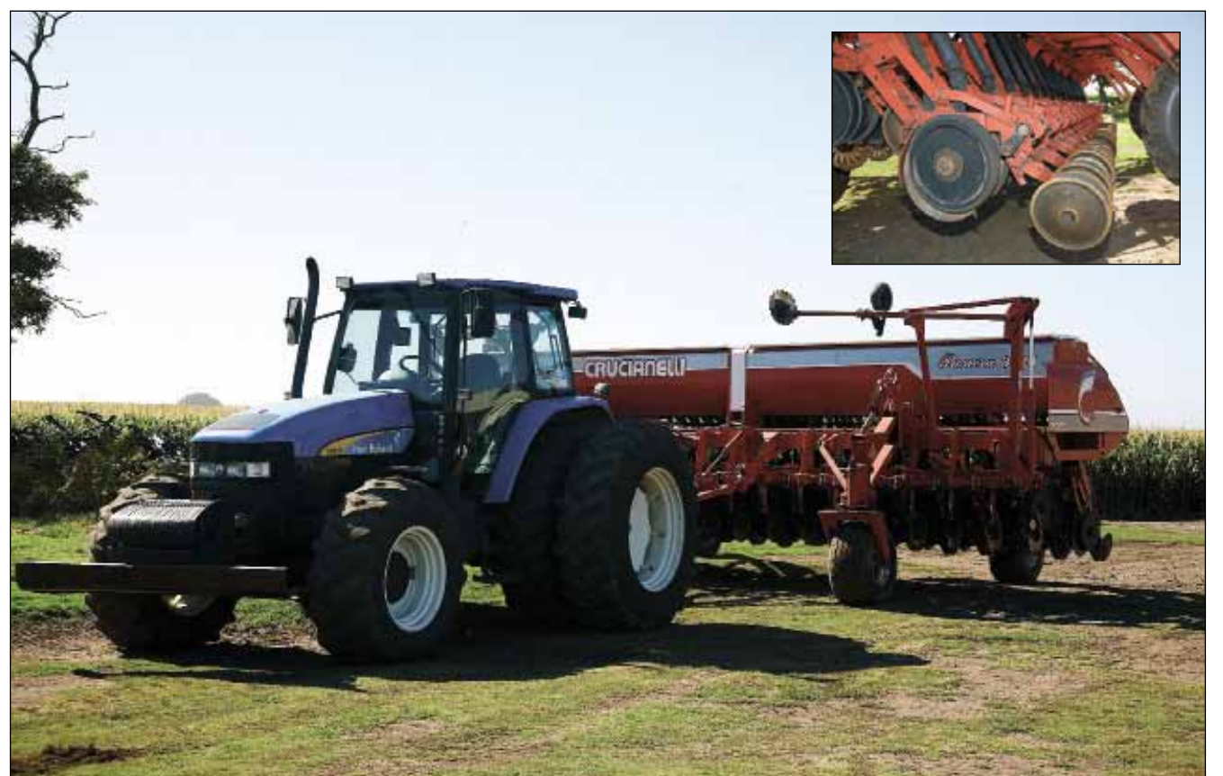
Her er Sean Camerons største traktor spændt for den direkte såmaskine. Når der sås hvede og soja, er farten syv-otte km/t, mens den er seks-syv km/t ved såning af majs. Nærbilledet viser opbygningen af såenhederne.
